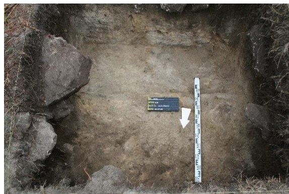
Fotos 3 e 4. Contraste no plano final entre características geológicas: sondagem D2 (rocha) e D1 (alterite granítica).
