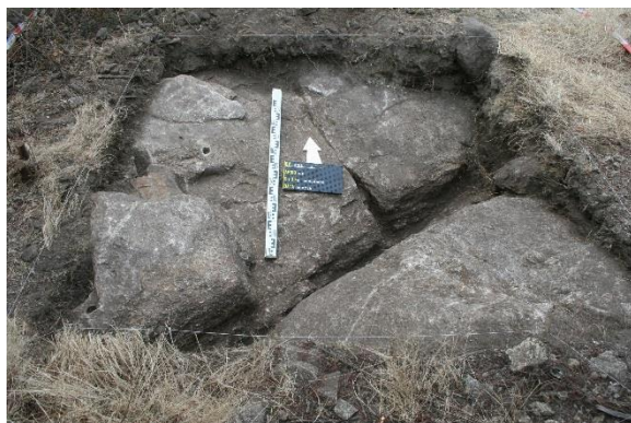
Fotos 3 e 4. Contraste no plano final entre características geológicas: sondagem D2 (rocha) e D1 (alterite granítica).
