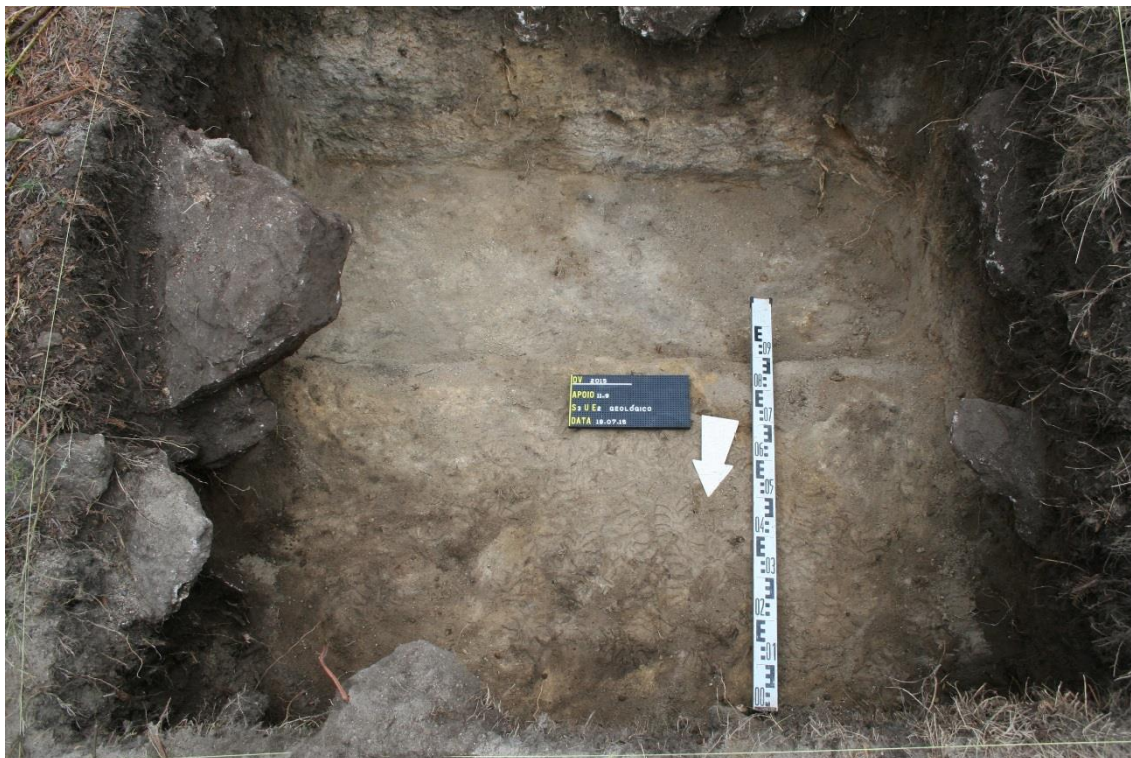
Foto 4. Apoio 11/9. Sondagem D1. Plano final e características geológicas (alterite granítica).
